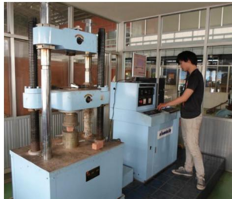
รูปที่ 3 ทดสอบกำลังรับแรงอัดดินซีเมนต์ผสมน้ำยาหงพารา
