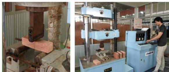
รูปที่ 3 ทดสอบกำลังรับแรงดัดดินซีเมนต์ผสมน้ำยาหงพารา
