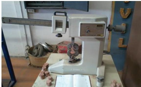
รูปที่ 4 การทดสอบกำลังรับแรงดึงดินซีเมนต์
