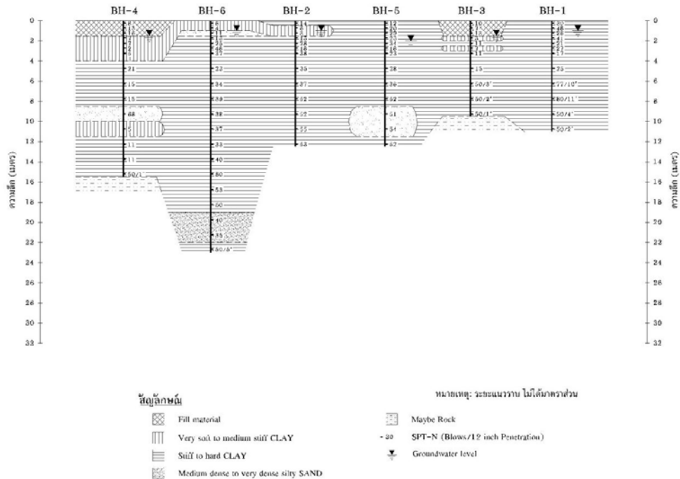
รูปที่ 5 ความลึกของหลุมเจาะสำรวจเพิ่มเติม 6 หลุม
