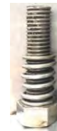
รูปที่ 5 สกรูปรับปริมาตรแบบละเอียดแบบเก่า
