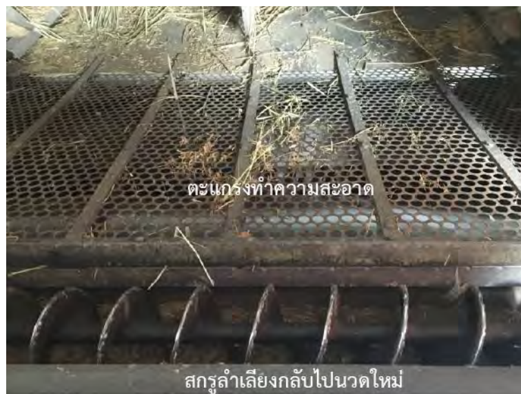
รูปที่ 1 สกรูลำเลียงสำหรับนำเมล็ดข้าวเปลือกกลับไปนวดใหม่ในรถเกี่ยวและนวดข้าว
