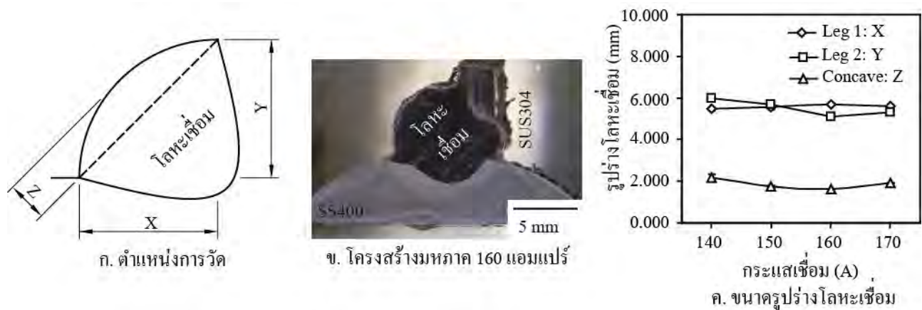
รูปที่ 6 รูปร่างและขนาดของโลหะเชื่อมรอยต่อตัวที่
