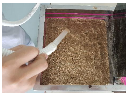
รูปที่ 9 การจำลองการขุดด้วยการดูดทรายในแบบจำลอง
