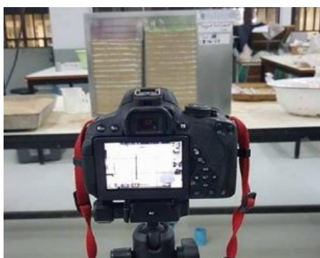
รูปที่ 8 ติดตั้งกล้องถ่ายรูปเพื่อบันทึกค่าการเคลื่อนตัว
