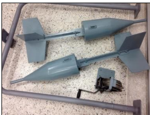
รูปที่ 5 เครื่องมือเก็บวัดความเข้มข้นตะกอนแขวนลอย
