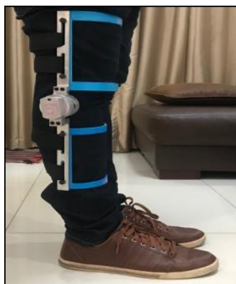
รูปที่ 2 การติดตั้งข้อต่อแรงเสียดทานต้นแบบบนขาของผู้เข้าร่วมทดลอง
