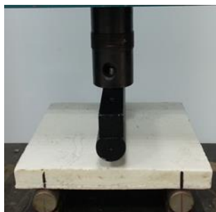
รูปที่ 4 การทดสอบกำลังรับแรงดัดโดยใช้แรงกดที่กึ่งกลางของแผ่นปูพื้นทางเดิน
