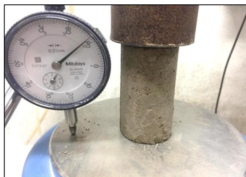
รูปที่ 3 การทดสอบแรงอัดแกนเดียว (Unconfined Compression Test)
