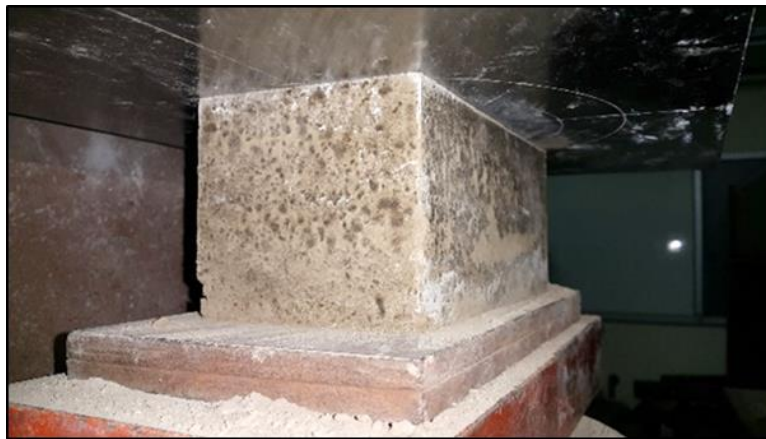
รูปที่ 4 การวิบัติของตัวอย่างอิฐบล็อกดินตะกอนบนแท่งทดสอบกำลังอัด
