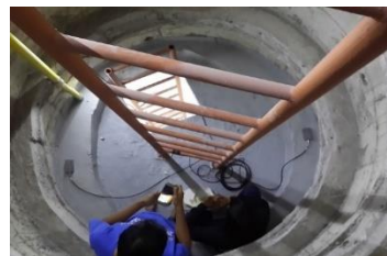
รูปที่ 3 การติดตั้งเครื่องวัดความเร่งเพื่อหาคณสมบัติเชิงพลศาสตร์ในระนาบราบ ณ ความสูง 53.14 เมตร
