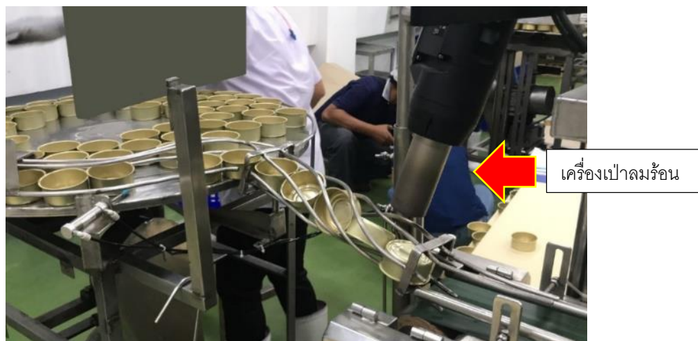
รูปที่ 7 ตำแหน่งติดตั้งชุดเครื่องเป่าลมร้อนบนผิวกระป๋อง
