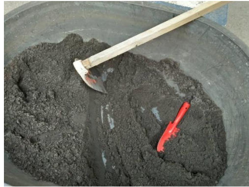
รูปที่ 3 เถ้าขานอ้อยที่ใช้ในการศึกษาครั้งนี้ (ซ้าย) และเถ้าขานอ้อยผสมซีเมนต์เพื่อใช้เป็นวัสดุสำหรับงานบดอัด (ขวา)
