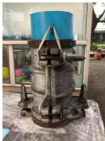
รูปที่ 5 แบบเหล็ก (Mold) ขนาดเส้นผ่านศูนย์กลาง 10 ซม. ความสูง 20 ซม. (ซ้าย) และปัญหาตัวอย่างดินผนังแบบหลังการบดอัด (ขวา)
