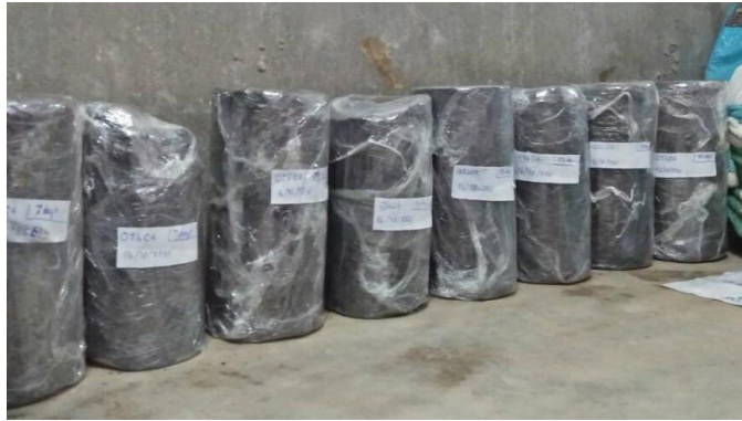
รูปที่ 6 ตัวอย่างเก้าขานอ้อยผสมซีเมนต์บดอัดขนาดเส้นผ่านศูนย์กลาง 10 ซม. ความสูง 20 ซม. ที่บ่มไว้ในห้องเก็บตัวอย่าง
