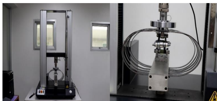
รูปที่ 6 การทดสอบแบบสถิตย์บนเครื่องทดสอบ Universal testing machine
