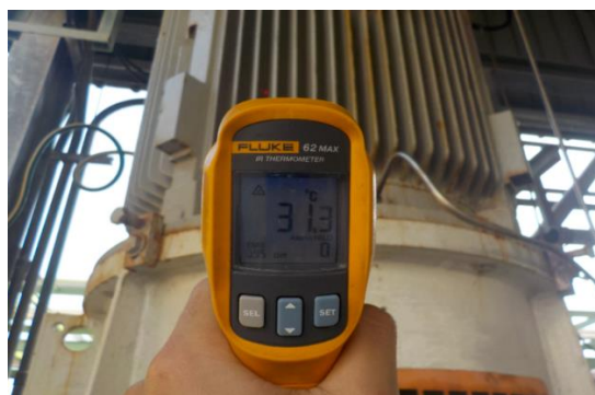
รูปที่ 3 การตรวจสอบอุณหภูมิคลัทช์ลูกปืนของมอเตอร์ไฟฟ้าด้วยปืนวัดอุณหภูมิ
