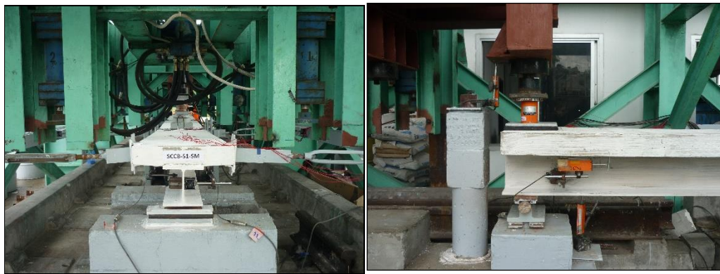
รูปที่ 4 การทดสอบคานเหล็ก-คอนกรีตชนิดคอมโพสิต ซึ่งมีปลายแบบยึดรั้งและฐานรองรับแบบยึดรั้ง (Restrained support)
