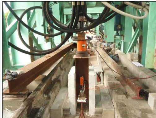
รูปที่ 2 การทดสอบกำลังรับแรงเฉือนของตัวยึดรับแรงเฉือน
