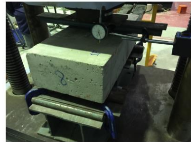
รูปที่ 6 การทดสอบแรงดัด ตามมาตรฐาน ASTM C 293-02
