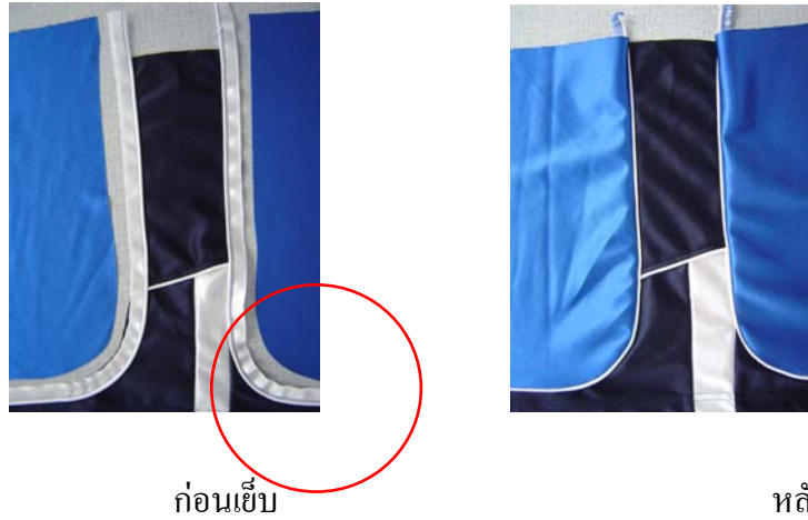
รูปที่ 3 แสดงชิ้นงานในขั้นตอนโพงก๊อเส้นต่อขาหน้าของผลิตภัณฑ์กางเกง
