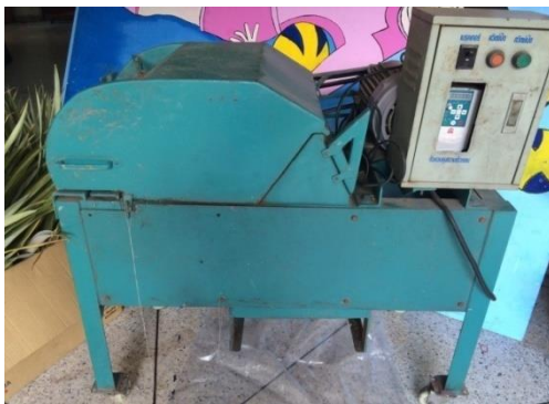
ภาพที่ 2 เครื่องแยกเส้นใยแบบกึ่งอัตโนมัติ
